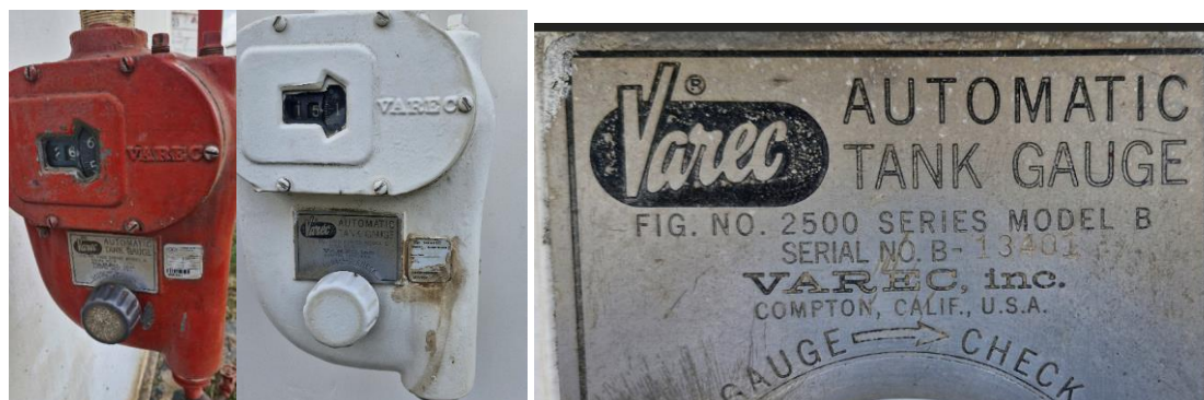
Figura 3. Medidores de nivel marca VAREC TK 102 y TK 101.
